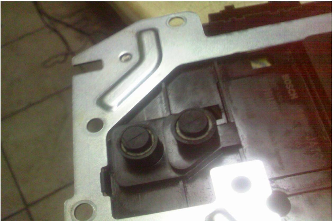
Желательно проверить работу датчиков перед установкой в коробку. Подключение блока по питанию см. в тех. Документации. Одеваем защитную крышку. Ставим ЭБУ на гидроблок и т.д.
