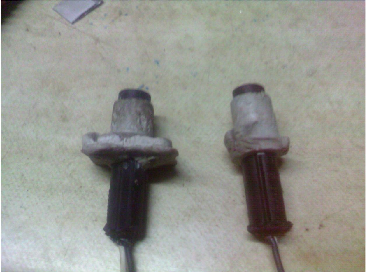
После этого паяльником аккуратно обрезаем лишнюю часть корпуса. При изготовлении нужно иметь в виду, что провода в корпусе датчика перекручены и их выходные концы при обрезке корпуса могут изменить положение относительно уже готового кронштейна ,поэтому лучше сделать кронштейн для начала круглым ,сориентировать провода готового датчика для пайки на эбу как надо, а потом доделать остальную часть кронштейна .
