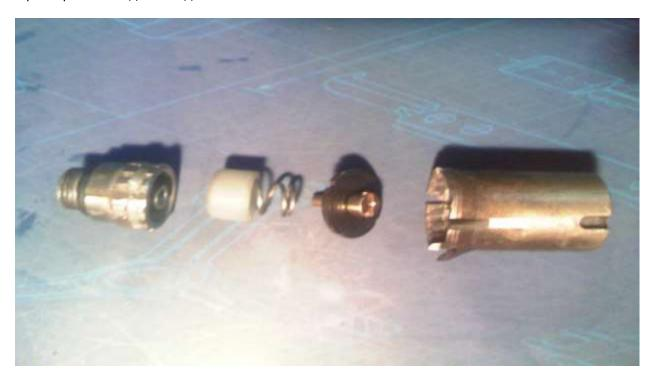
Далее, можно его демонтировать и проверить на исправность . ( обратный клапан рассчитан на давление около 3,5 кг) Т.е при исправном пневмобаллоне и клапане остаточное давление внутри, всегда около 3кг. Повреждения резиновой оболочки тоже можно определить с помощью нанесения мыльного раствора , но этим способом ,не всегда возможно выявить утечку визуально. Также при повреждении нижнего пластикового кожуха вероятность повреждения пневмобаллона очень высока.
