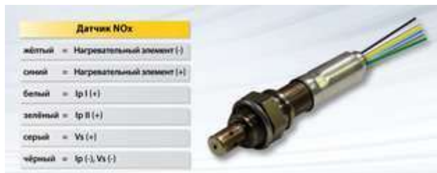
Расположение кабеля кислородного датчика NOx
